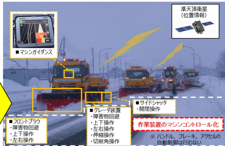
一次除雪機械(除雪トラック)のマシンコントロール化イメージ
