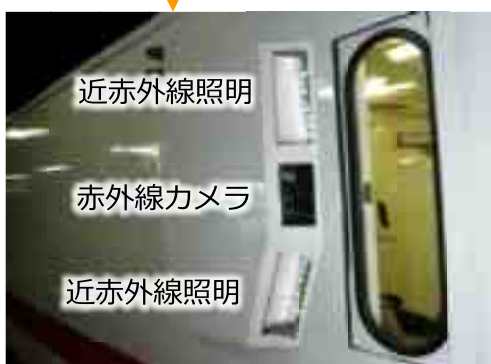
建築限界撮影カメラ (側面上下) 建築限界付近の物体をデジタルビデオ 画像として撮影する
