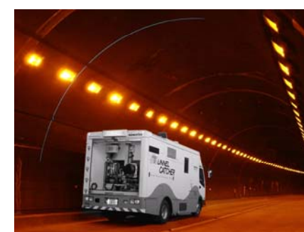
レーザーによる ひび割れの検出
