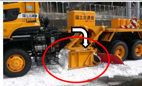
サイドシャッターで雪を抱えている状況 ※除雪により押しのかけた雪が、交差点に残らないための装置
