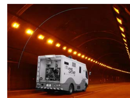
レーザーによる ひび割れの検出
