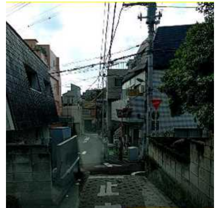
道路領域検知失敗の例 （スマホの設置角度によっては、道路領域が正しく検出できない）
