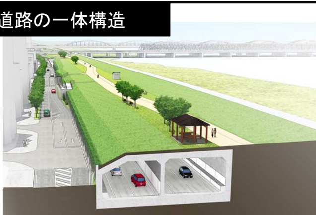
堤防と道路構造物の一体構造物として整備し、トンネル上部空間には歩行者専用道を設置
