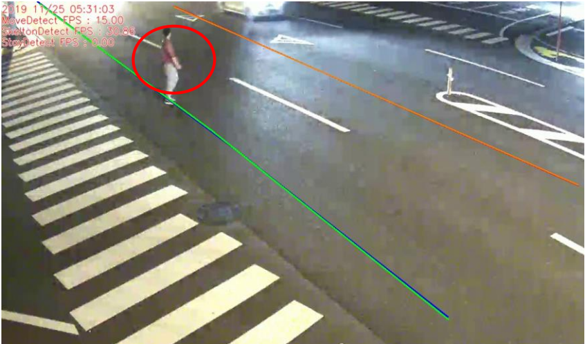
■ 車両のライトにより、対象人物部分の画質・コントラストが悪化した例
