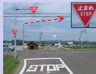
【「STOP」の補助標識、路面標示設置】
