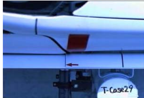
3) 運転席ドア部分が継ぎ目に接触
