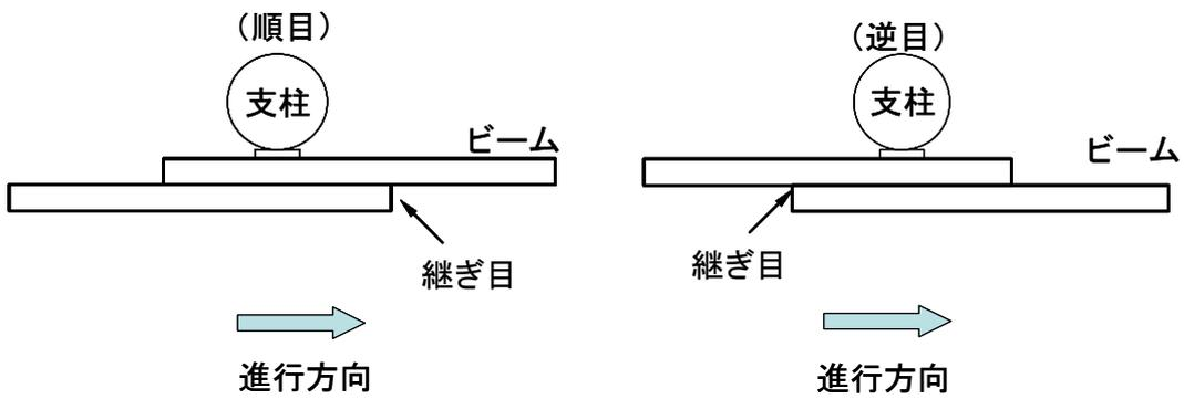
金属片の付着形態「順方向」、「逆方向」、「突出」の定義
