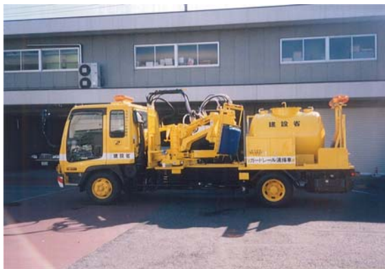
写真 7-1 実験に使用したガードレール清掃車と作業装置
