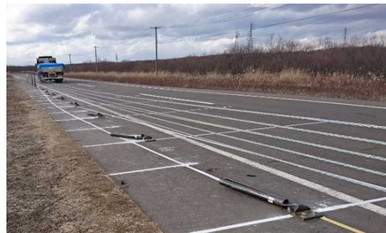
衝突実験後の支柱状況写真(H29.11.15)
