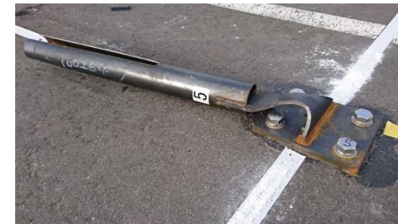
衝突実験後の支柱状況写真(H29.11.15)
