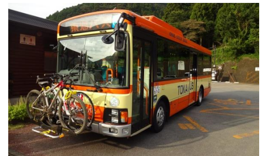
＜サイクルラックバス(静岡県 東海バス)＞ 【出典：東海バス資料】
