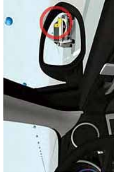
車線変更警報システム(イメージ)
