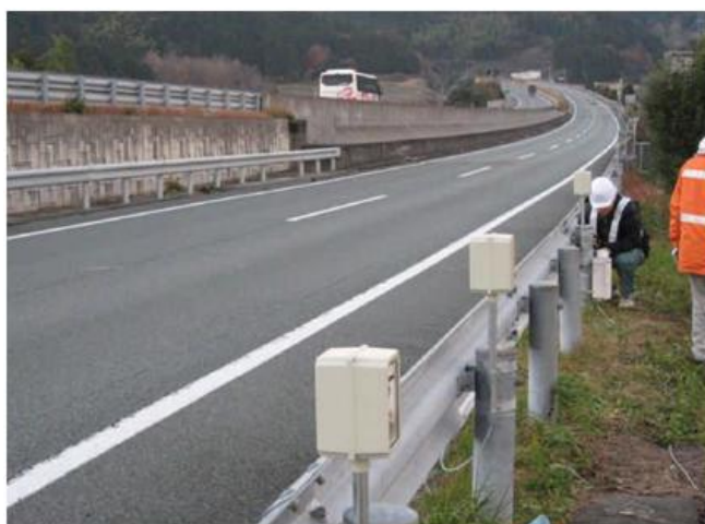
可搬式トラフィックカウンター(車両感知器) による交通量調査
