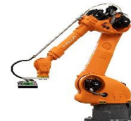
ピッキングロボット
