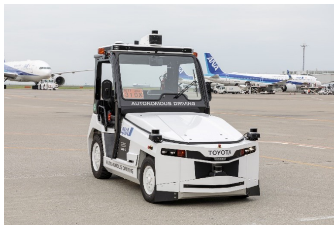
写真: 開発中の自動運転トーイングトラクター(3TE25)
