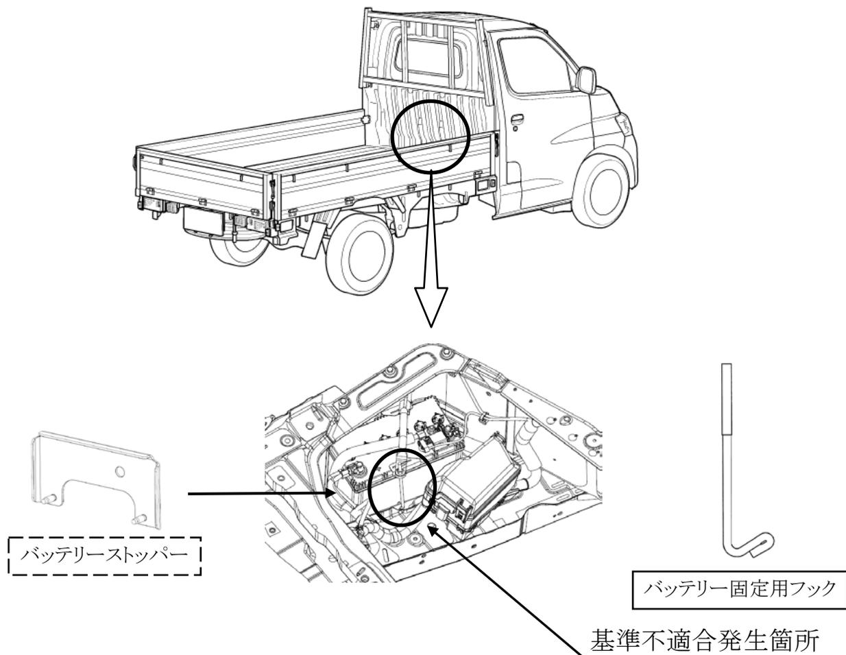
バッテリーの固定具において、開発時の検証が不十分であったため、後方から衝突を受けた際にバッテリーが過度に移動するとともに固定具が外れる場合があり、バッテリーが所定の位置に保持されないおそれがある。
