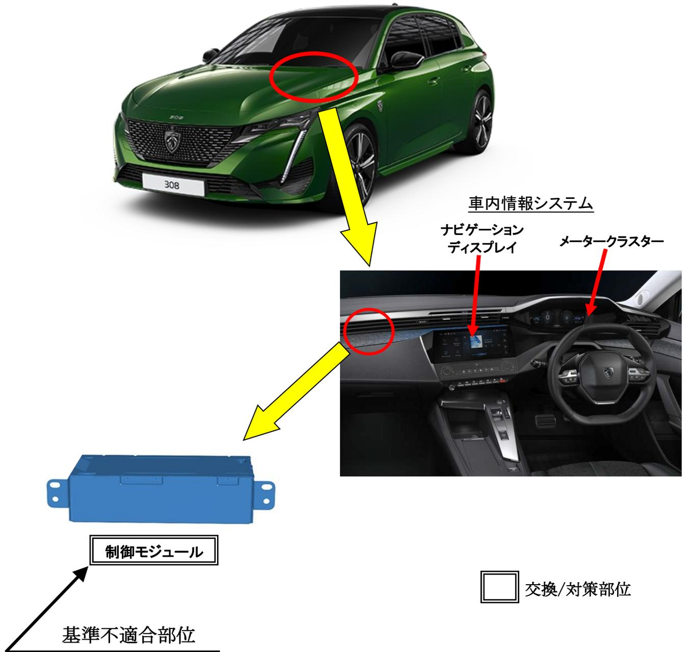
〔 車内情報システム(ナビゲーション、オーディオ等の統合システム)において、制御プログラムが不適切なため、ナビゲーションディスプレイとメータークラスターが消灯し、速度の確認が出来なくなるおそれがある。 〕
