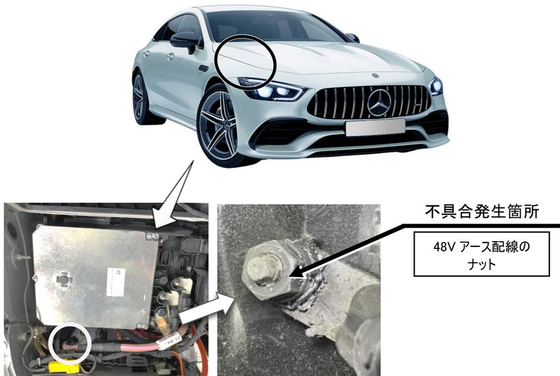
注:  は、締め付けトルクを点検する部位を示す。
