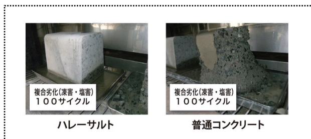
写真—1 複合劣化試験
