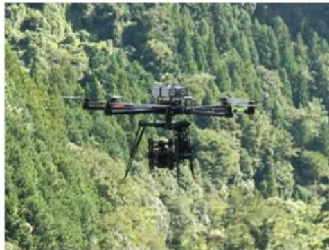
ドローンによる画像計測
