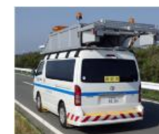
3次元レーザーセンサ を用いた舗装損傷検知
