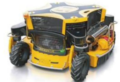
遠隔操縦式草刈機による除草
