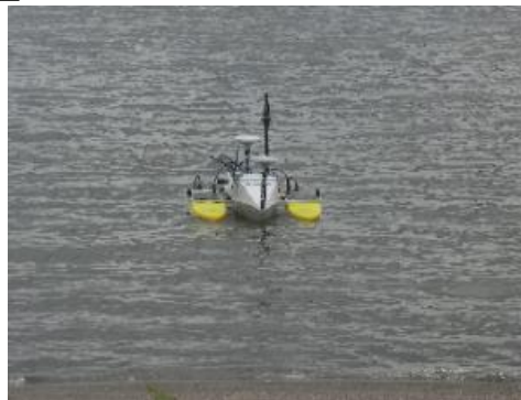
無人ボートによる堆砂測量
