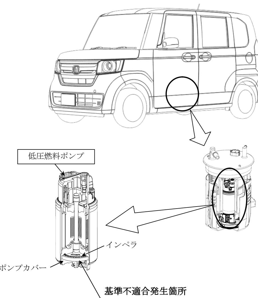
〔 低圧燃料ポンプのインペラ（樹脂製羽根車）において、成形条件が不適切なため、樹脂密度が低くなって、燃料により膨潤して変形することがある。そのため、インペラがポンプカバーと接触して燃料ポンプが作動不良となり、最悪の場合、走行中エンストに至るおそれがある。 〕
