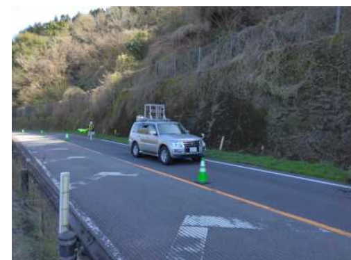
MMS※1を活用した点検技術
