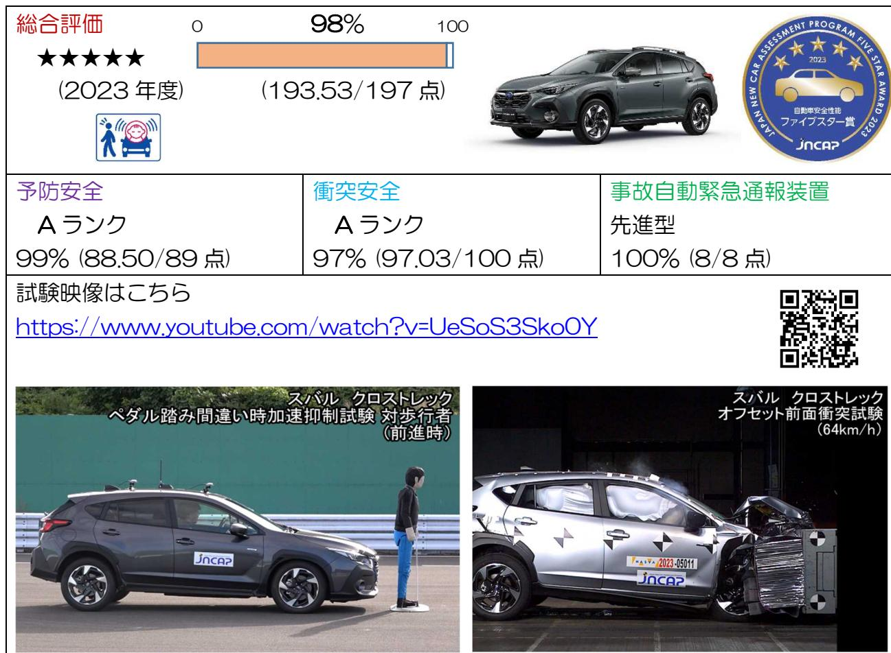
※「自動車安全性能 2023」より「ペダル踏み間違い時加速度抑制装置」の評価に、歩行者との事故に対応した評価を新たに導入しました。評価内容の変更に伴い配点の変更があるため、安全性能について過去に評価した車種との点数の大小による直接比較は出来ません。
