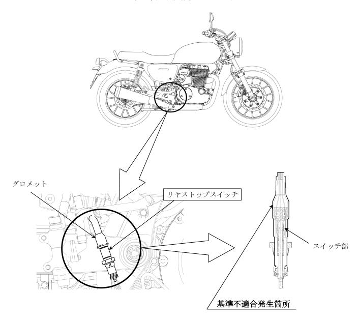
リヤストップスイッチにおいて、防水用グロメット材料の配合が不適切なため、耐久性が不足しているものがある。そのため、オゾン劣化により当該グロメットに亀裂が発生し、スイッチ内部に雨水等が浸入してスイッチ接点部に付着すると、ブレーキペダルを踏まなくても制動灯が点灯し、最悪の場合、スイッチ接点部が導通不良となりブレーキペダルを踏んでも制動灯が点灯しないおそれがある。
