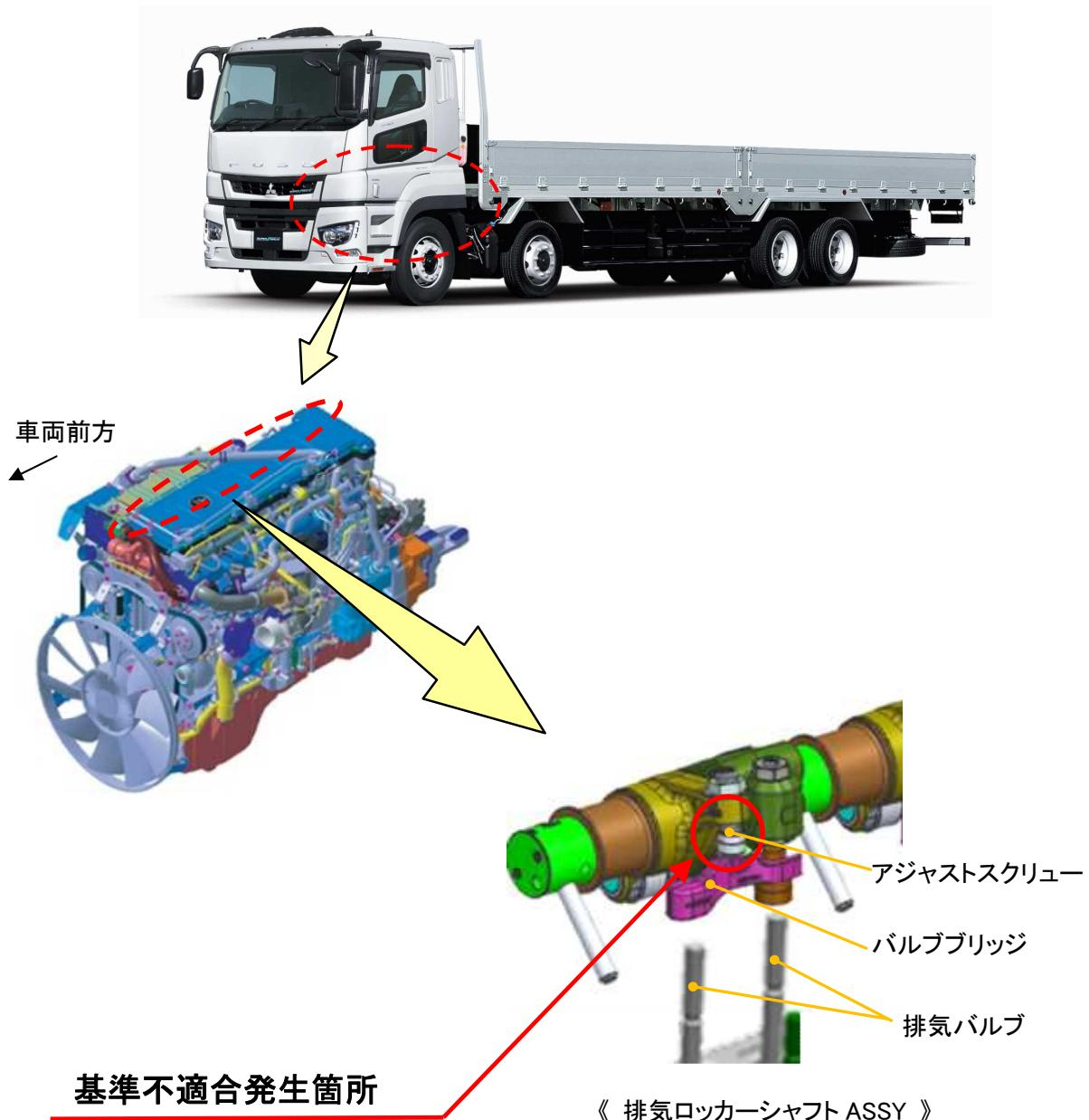
6R20型エンジンを搭載した大型トラックにおいて、排気ロッカーアームのアジャストスクリューの潤滑性能が不十分なため、長時間のアイドル運転を行うと早期にアジャストスクリューが摩耗及び破損して異音や出力の低下が生じることがある。そのため、そのままの状態で使用を続けると、バルブブリッジが脱落してエンジンが破損し、最悪の場合、走行不能に至るおそれがある。
