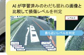
<掲載技術名>汎用機材を用いたAI舗装損傷診断システム(マルチファインアイ) (検出項目:ひび割れ率)
