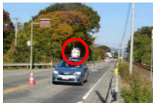
車載装置による路面性状測定
