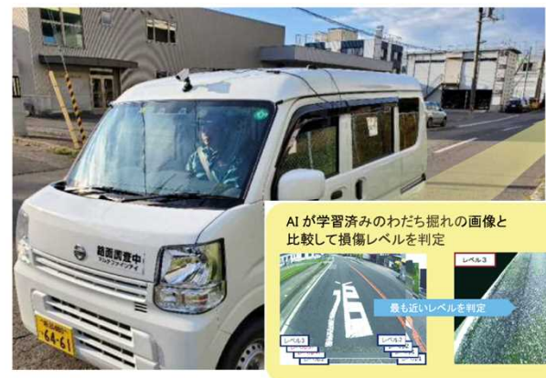
<掲載技術名>汎用機材を用いたAI舗装損傷診断システム(マルチファインアイ) (検出項目:ひび割れ率)
