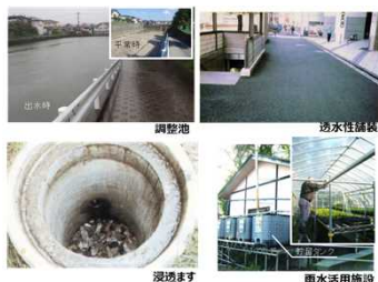
雨水貯留浸透施設の例
