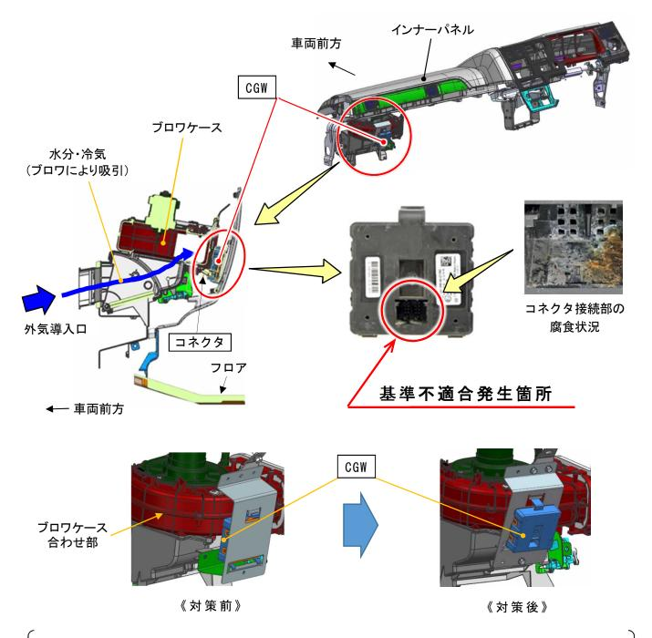
大型トラックにおいて、車室内の空調用ブロワ後方に装着されているCGW (Central Gate Way : 信号のやり取りをする ECU) の搭載位置が不適切なため、ブロワケース内部に取り込んだ外気に含まれる水分がケース合わせ部から滲み出してCGWのコネクタ端子に滴下すると、当該端子とCGWの内部基盤に腐食や損傷が生じるものがある。そのため、走行中のエンジン停止、エンジン再始動不能、PTO作動不能、コンビネーションスイッチの不作動等の不具合が発生するおそれがある。
