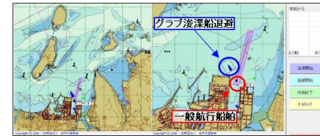
「航路浚渫支援システム」モニター図
