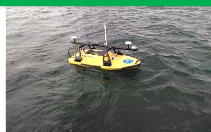
リモコンボートによる測量状況
