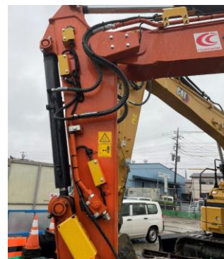
後付けICTシステムでICT建機化
