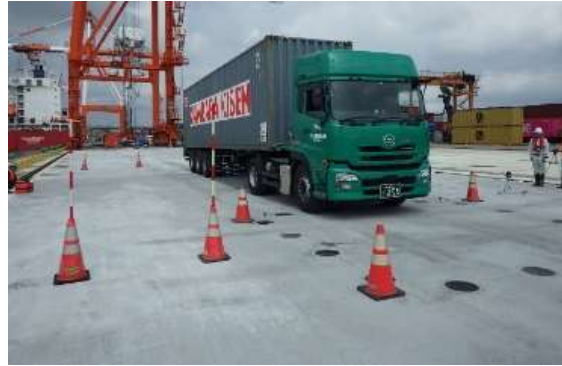
動的載荷試験の様子
