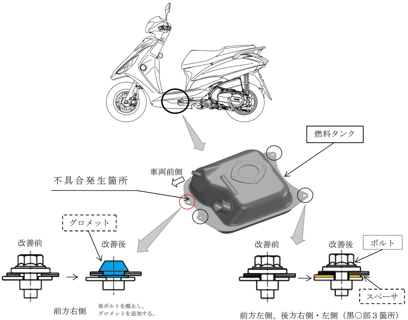
燃料タンクにおいて、取付け構造が不適切なため、悪路等を繰り返し走行すると、燃料タンクの前方右側取付け部付近に過大な力が加わり、亀裂が生じるものがある。そのため、そのままの状態で使用を続けると、亀裂が進行し、最悪の場合、燃料が漏れるおそれがある。
