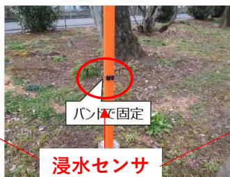
支柱への取付け
