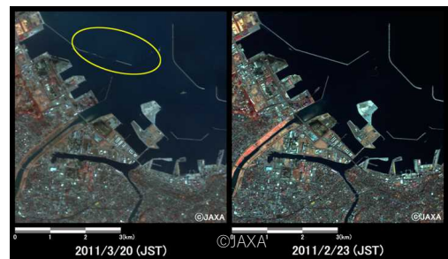
「だいち」初号機の光学画像による港湾の状況把握 (H23 東日本大震災 防波堤の損壊を確認)
