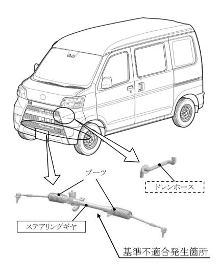
ステアリングギヤにおいて、ブーツ取付け部のシールが不適切かつエアコンドレンホースが直上にあるため、エアコン凝縮水が当該取付け部に滴下しギヤ内部に浸入するものがある。そのため、そのままの状態で使用を続けると、ギヤ内部に錆が生じて異音が発生し、最悪の場合、ベアリングが破損し操舵ができなくなるおそれがある。
