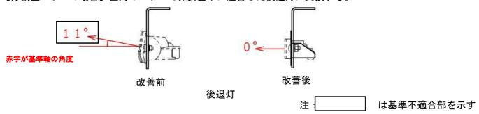
ダンプ車等において、後退灯およびリヤコンビネーションランプの取付が不適切なため、後退灯、制動灯、尾灯、 後部反射器および方向指示器の取付角度が保安基準に定める要件にそれぞれ適合しない。
