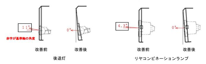
【分割型ステーの場合】直角のステーで保安基準に適合した後退灯に交換する。
