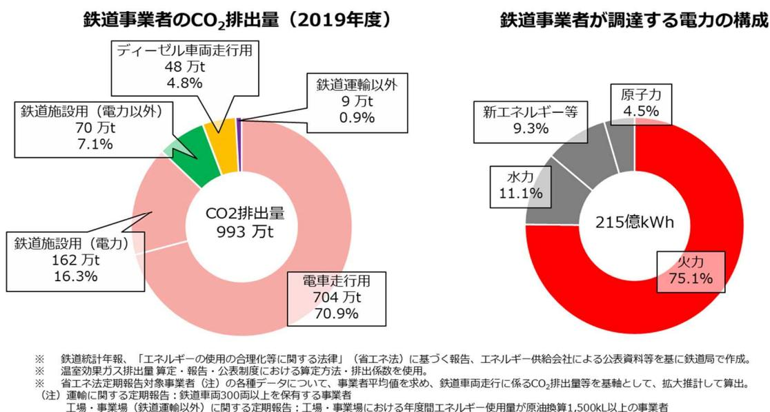
図-1 鉄道事業者のCO<sub>2</sub>排出量（左）、鉄道事業者が調達する電力構成（右）
