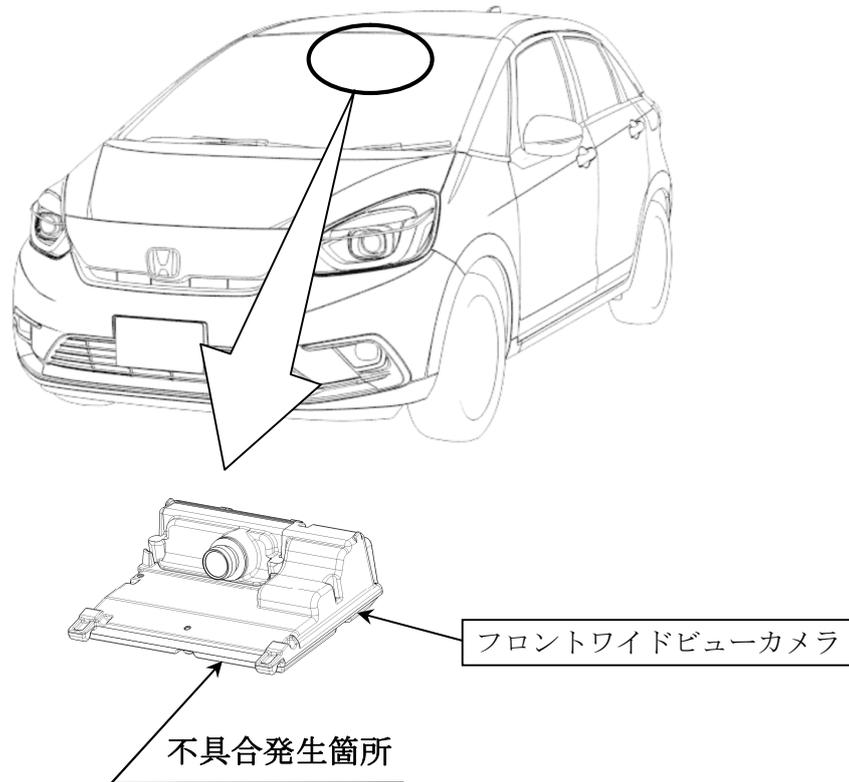
安全運転支援システム（Honda SENSING）において、フロントワイドビューカメラの起動処理プログラムが不適切なため、車両起動時に当該カメラが起動しないことがある。そのため、衝突被害軽減ブレーキ等が非作動状態であるにもかかわらず表示灯がオン表示となり、非作動であることを運転者が認知できないおそれがある。
