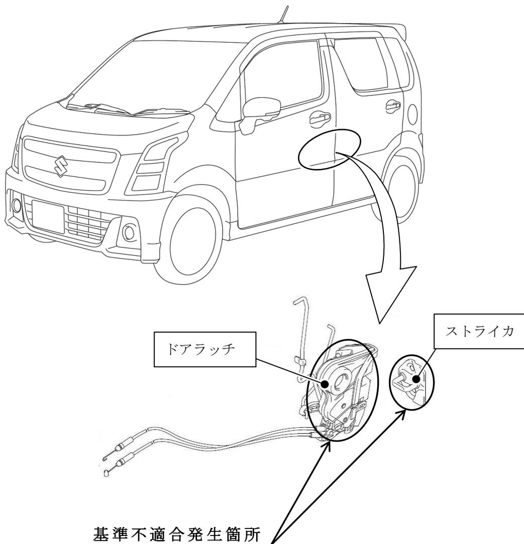
前席ドアにおいて、ドアラッチ及びストライカの設定が不適切なため、側面衝突時にサイドエアバッグが展開するとドアラッチが変形するものがあり、最悪の場合、ドアラッチとストライカの噛合いが解除され、前席ドアが開くおそれがある。
