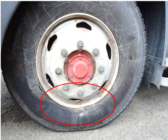
写真10 縁石に接触した左前輪 接触痕（○印）
