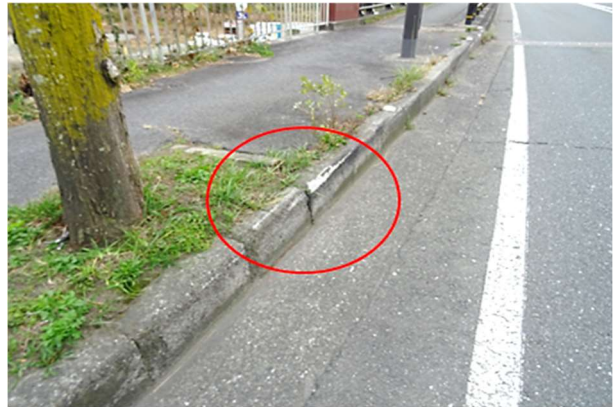
写真7 事故地点手前左側の縁石に残さ れた当該車両の左前輪の接触痕（○印）
