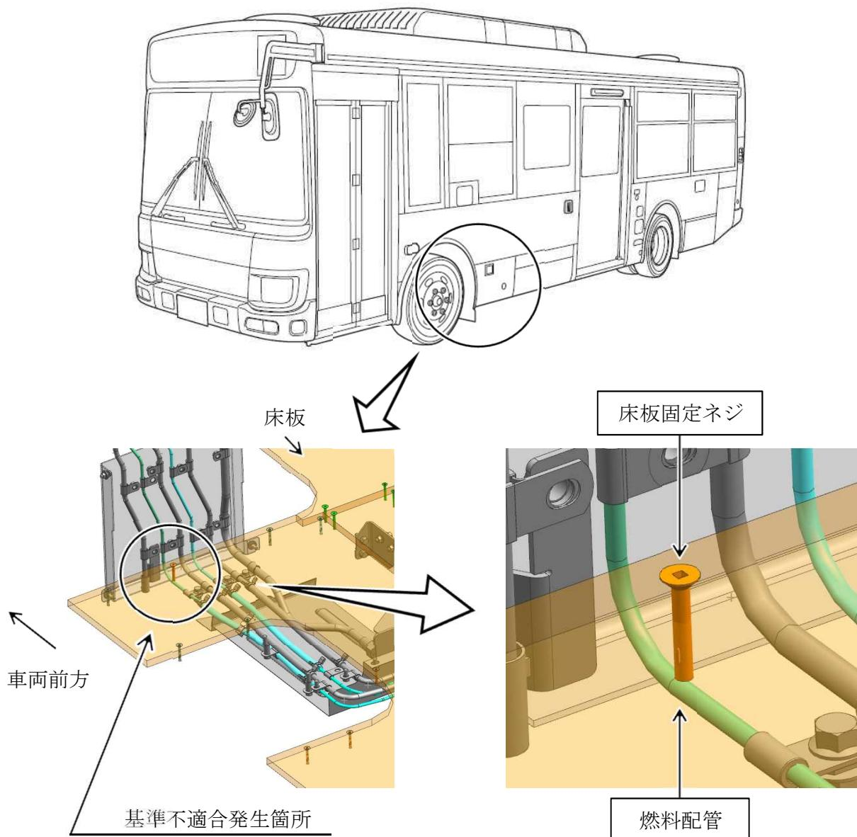
中型バスにおいて、床板固定ネジの締結位置が不適切なため、当該ネジの先端が燃料配管に干渉することがある。そのため、燃料配管が損傷し、燃料が漏れるおそれがある。
