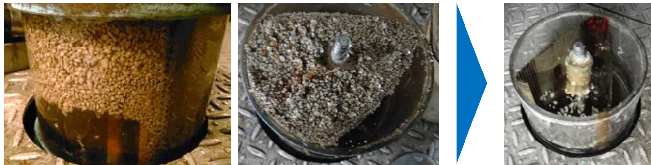
エレメントの目に詰まる軽石（撮影：沖縄総合事務局職員）
