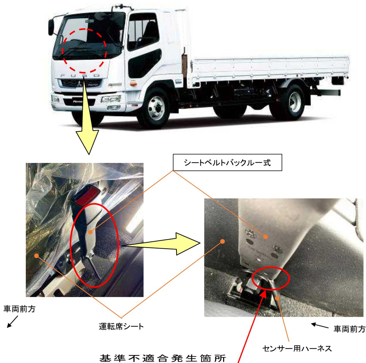
中型トラックにおいて、運転席のシートベルトバックルに取り付けられているシートベルト装着状況を検知するためのセンサー用ハーネスの配策が不適切なため、使用過程でシートベルトバックルが当該ハーネスを挟み込むことがあり、この繰り返しにより当該ハーネスが損傷し、シートベルト非装着警告灯と警報ブザーが誤作動するおそれがある。
