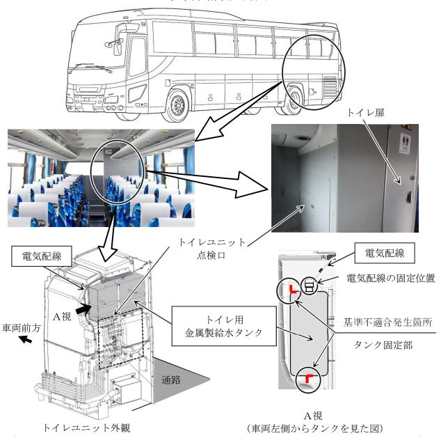
大型バスのトイレ用金属製給水タンクにおいて、タンク固定部の強度が不足しているため、固定部が損傷してタンクが脱落することがある。そのため、タンクに固定されているトイレ用電気配線が損傷して、火災に至るおそれがある。
