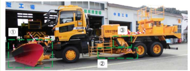
①フロントブラウ ②路面整正装置 ③サイドシャッタ 新雪を路外に飛ばす装置 圧雪を剥ぎ取る装置 交差点等で雪を抱え込む装置
