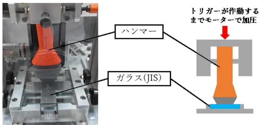
ハンマーの先端がガラス試験面に接触する位置から、突起物が飛び出す作動トリガーが作動するまで、モーターでガラス面に垂直に加圧します。これを3回繰り返します。
