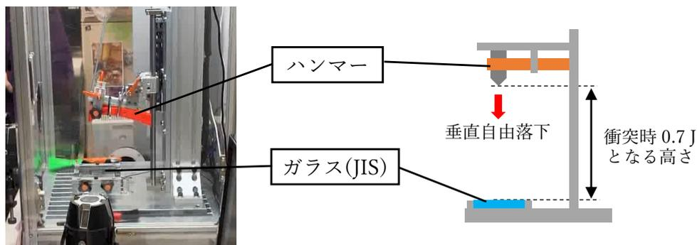
衝突時のエネルギーが0.7 J<sup>※3</sup>となる高さから、先端が垂直にガラス面に衝突するように、ハンマーを垂直自由落下させます。これを3回繰り返します。
