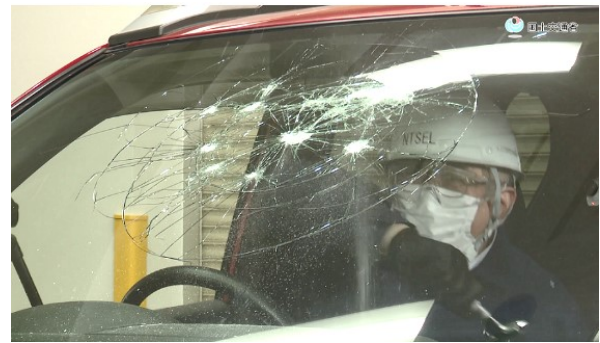
合わせガラスであるフロントガラスにハンマーを叩きつけ破碎しようとする様子
