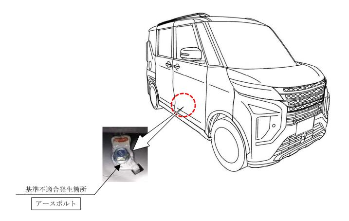
リチウムイオンバッテリーのアースボルトにおいて、車体への取り付けが不適切なため、アース不良 となるものがある。そのため、そのままの状態で使用を続けると、アイドリングストップ後再始動不 能またはエンジン停止不能となり、最悪の場合、車両火災に至るおそれがある。
